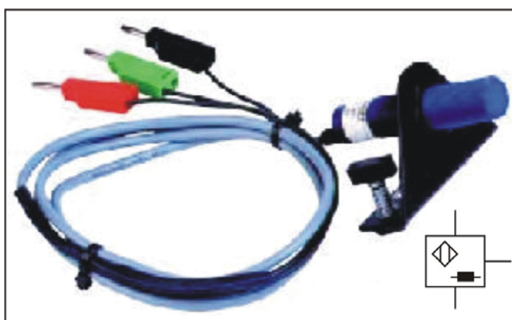
Fig. 12 – Sensor capacitivo e simbologia.
