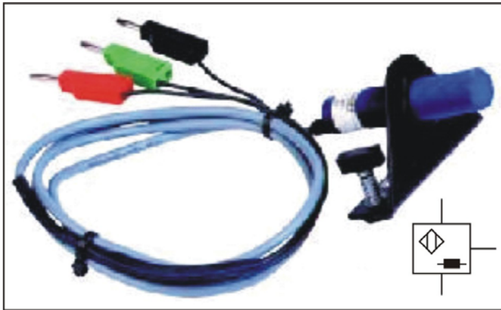
Fig. 4 – Sensor capacitivo e simbologia.
