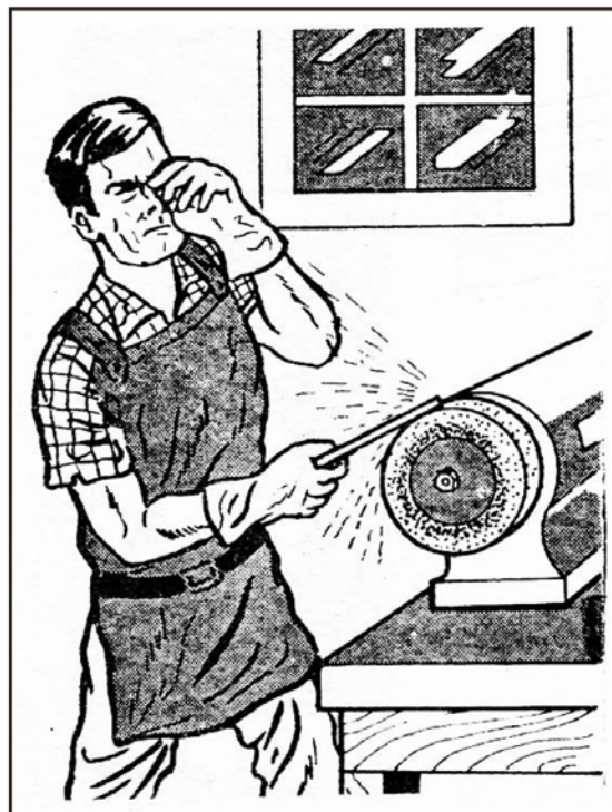
Fig. 25 - Falta de EPIs.
