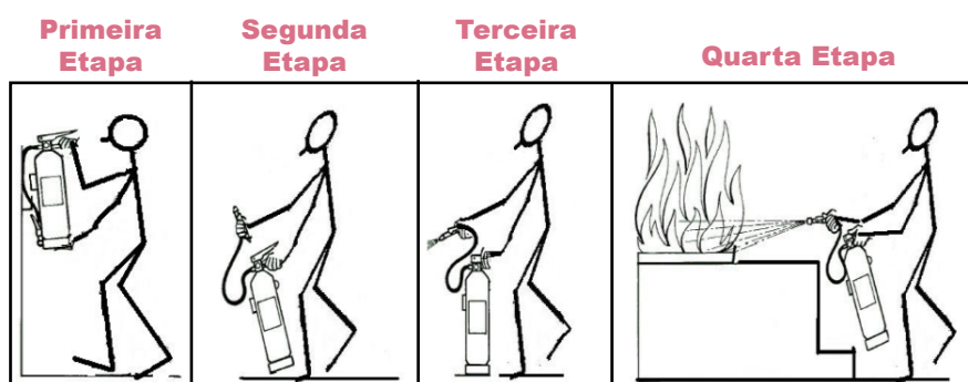
Fig. 3 - Utilização de um extintor de incêndios
