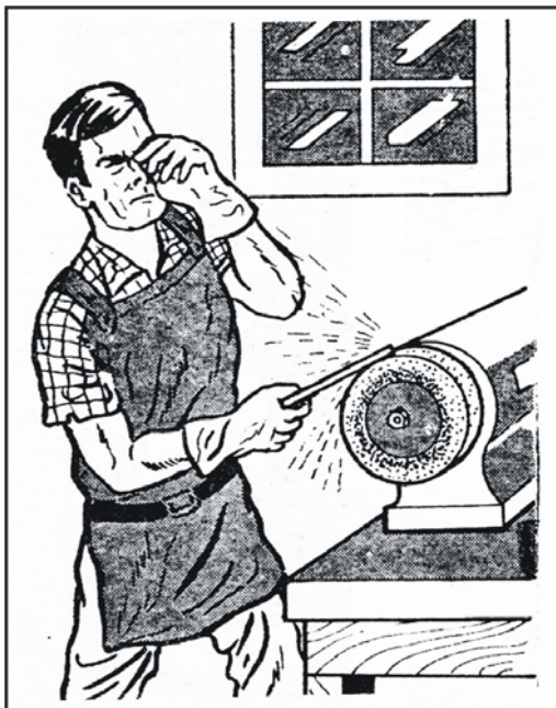
Fig. 21 – Falta de EPIs.
