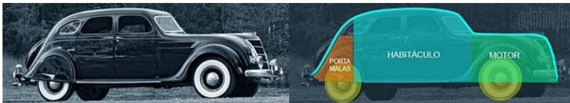
Figura 1: Divisões do veículo compreendidas pela carroçaria [2]
