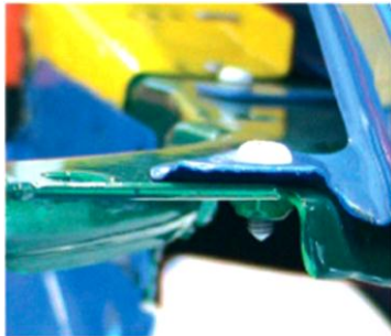
Figura 37: Utilização de parafusos numa carroçaria [51]
